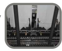
Destroncador: modular en tramos, montado sobre rodamientos autocentrantes y con centro hexagonal. Peine de 4 hileras de ataque. Puntones: dobles, con tratamiento térmico. Barra de Corte: modular en tramos, equipada con 3 secciones por línea de entrada de plantas. Regulación de Bandeja: manual.
