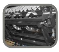
Adaptador de embocador intercambiable: Adaptable a todas las marcas y modelos de cosechadoras.
